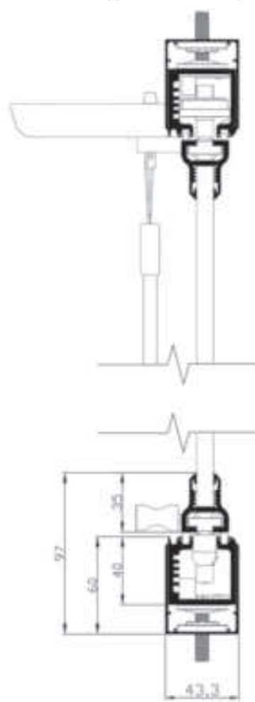
Sezione verticale con compensatore superiore e inferiore Vertical cross-section with upper and lower compensators
